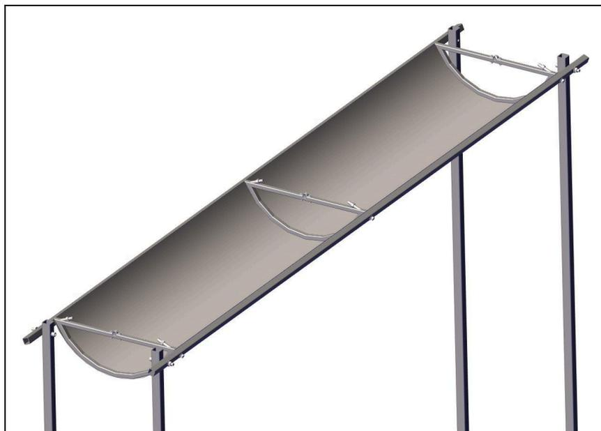
Ce document est la notice technique détaillée (version 2.0) pour le Cylindro-parabolique WFE V2 mécanique, un système conçu pour capter et concentrer les rayons solaires afin d'augmenter la température de l'eau brute. Il décrit les caractéristiques générales, les composants, le principe de fonctionnement, ainsi qu'un guide d'assemblage détaillé et les précautions de sécurité.
